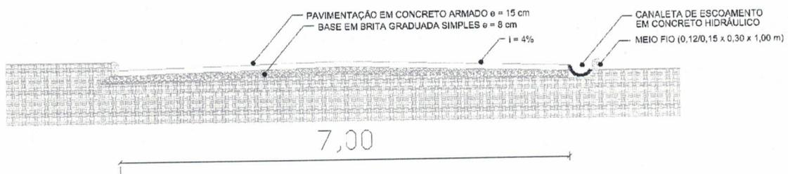
SEÇÃO TÍPICA DE PAVIMENTAÇÃO - Estrada dos Cauduros
